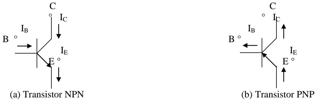
Figure II.7 : Symbole électrique d'un BJT.
