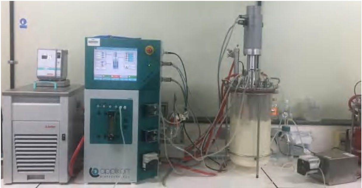
Figure 23. Modèle d'un bioréacteur autoclavable de 1-20 L « APPLICON ».
