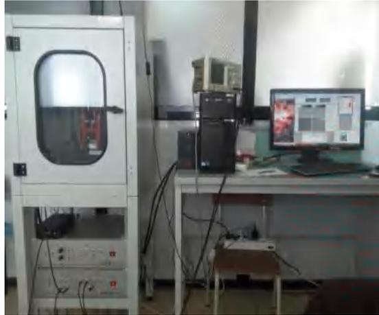
Figure II.11 : Photographie du microscope à force atomique A100-AFM avec système de contrôle SPM version 6.4.3. (Université d'Oum El Bouaghi)
