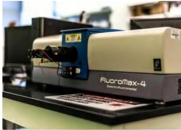
Figure II.14 : Spectromètre de luminescence Horiba Yvon Fluoro Max 4P fluorometer utilisé dans ce travail (Université Biskra)
