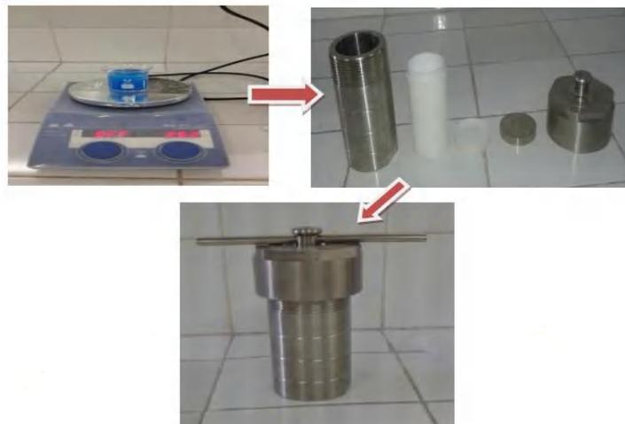
Figure II.3 : Autoclave utilisé pour la synthèse des nanoparticules de ZnTe et de ZnSe
