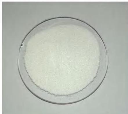
Figure II.5 : Poudre des particules du polymère PVC
