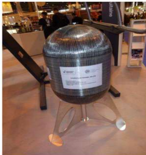
Figure I. 15: Réservoir haute pression (95L/700bars) type IV (poids 85 kg), réalisé par « Stelia composites » (salon du JEC 2013) [38]
