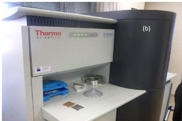
Figure 2. 9. Spectroscopie des photoélectrons X (a) Principe. (b) Appareillage
