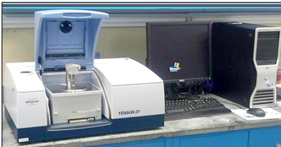
**Figure 2.6:** Spectrophotomètre Infrarouge TENSOR27
