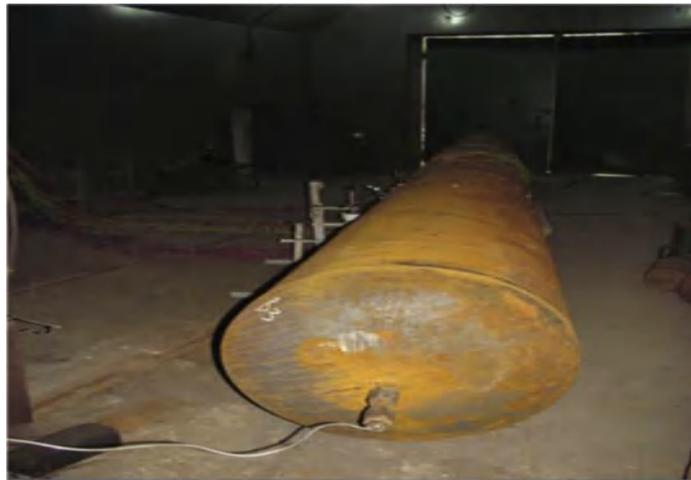
Figure I.16. Tube bosselé utilisé dans le test de pression [26]
