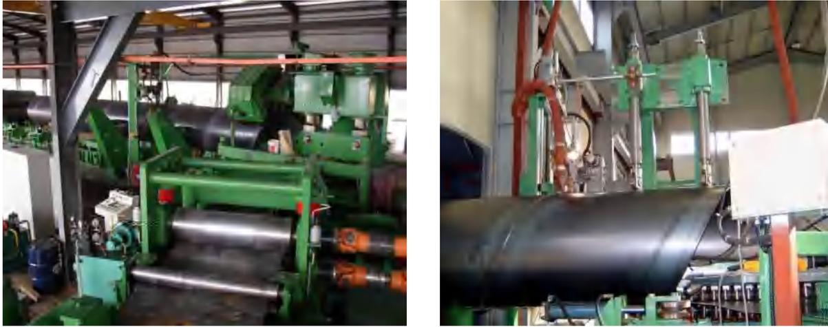
Figure I.29. Tubes soudés en spirale [54]
