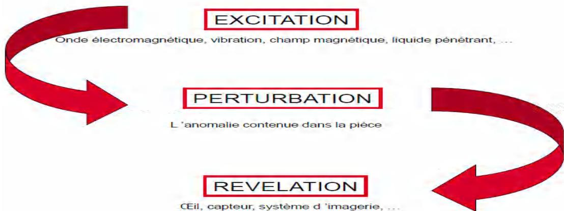
Figure I.46. Méthode indirecte de contrôle non destructif
