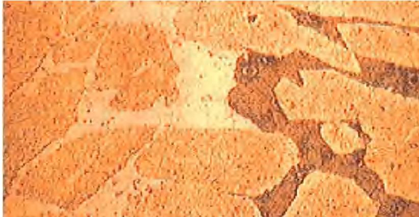
Figure I.38. Coupe métallographique montrant une corrosion sélective d'un laiton [56]
