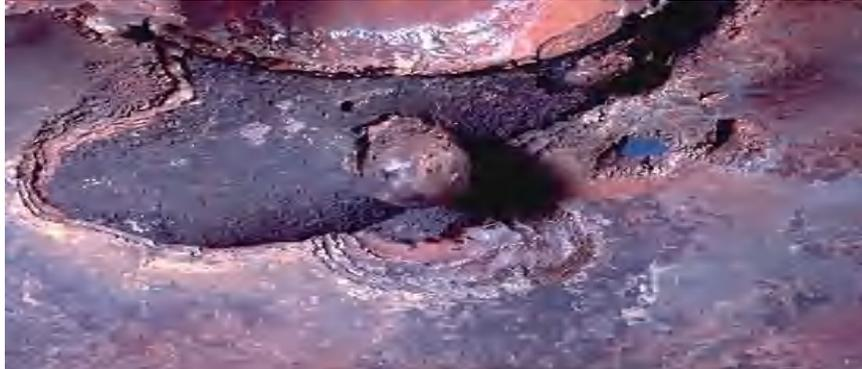
Figure I.35. Corrosion galvanique au niveau d'une zone de brasage entre la brasure Cu-P et le tube en cuivre
