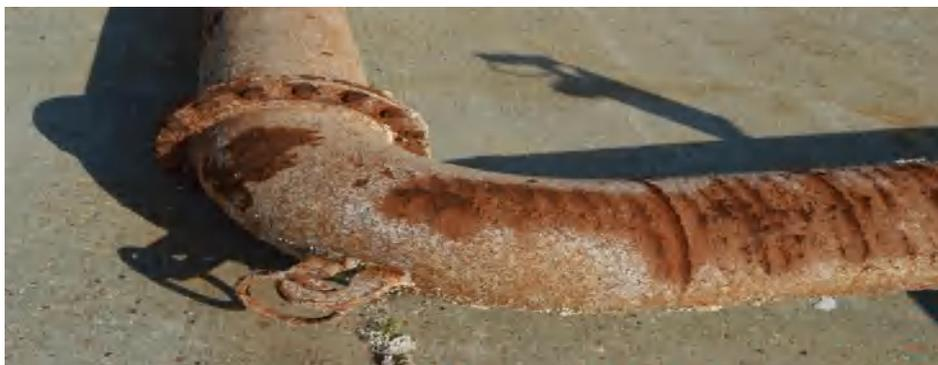
Figure I.32. Corrosion uniforme d'un pipeline [73]
