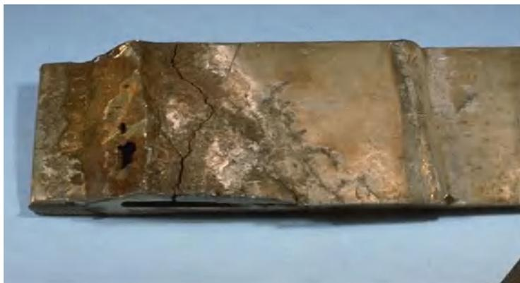
Figure I.39. Fissuration par corrosion sous contrainte dans une structure en acier allié soudé
