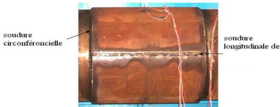
Figure IV.8 Réparation par demi coquille soudée [97]
