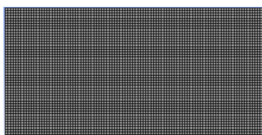
Figure III.19 Maillage linière de la plaque sans défaut
