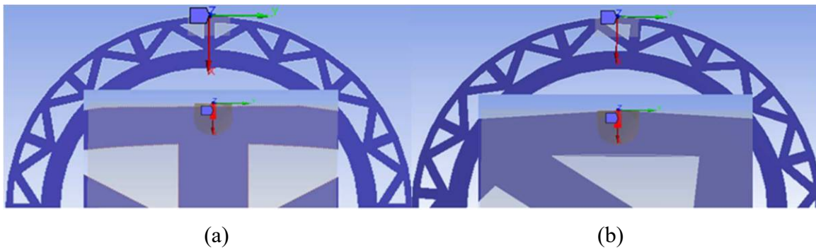
Figure III.74 Amorçage de fissure externe dans différentes zones. (a) zone I ; (b) zone II
