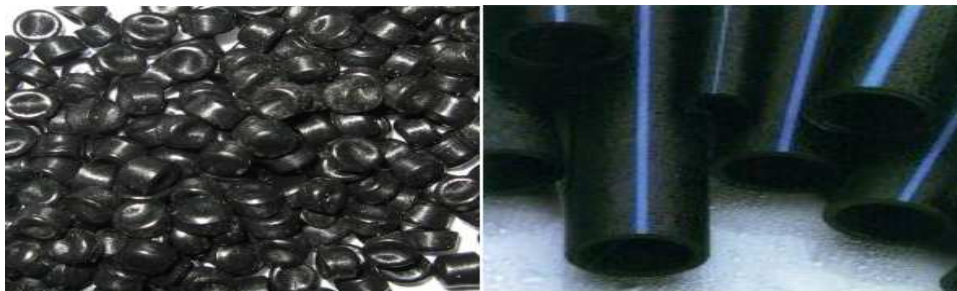
Figure I.8 Matière première PE sous forme de granulés et tube PEHD [11]
