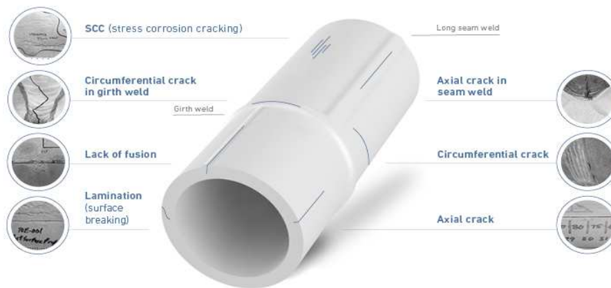
Figure I.16 Quelques exemples de fissures et de caractéristiques de pipeline
