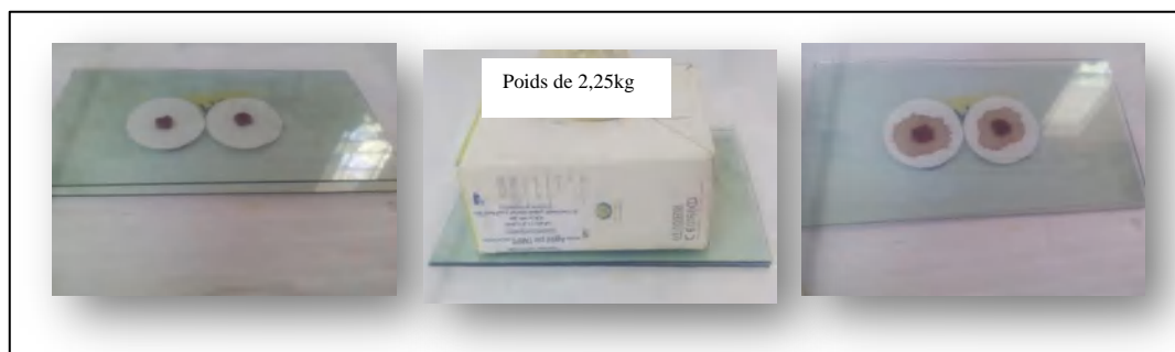
Figure 17. Mesure de la capacité de rétention d'eau par pression
