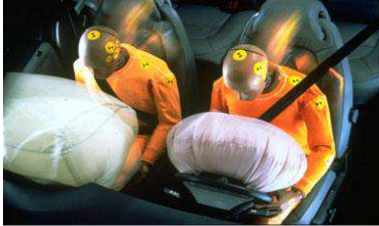
Figure II.10. Déploiement des airbags frontaux pour le conducteur et le passager avant [31].
