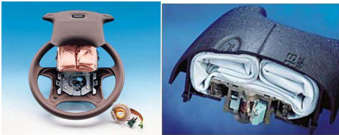
Figure II.26. Système de pliage de l'airbag conducteur [51].
