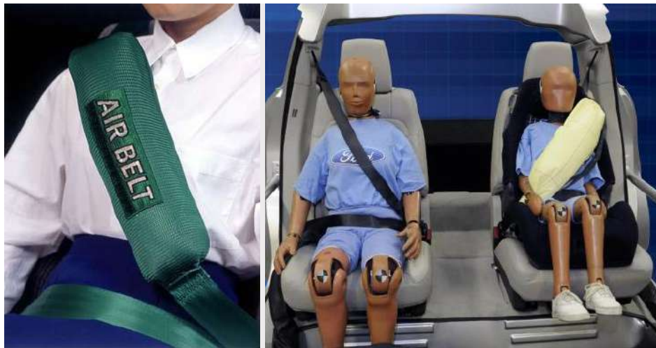
Figure II.14. Ceinture de sécurité active avec airbag gonflable [34].
