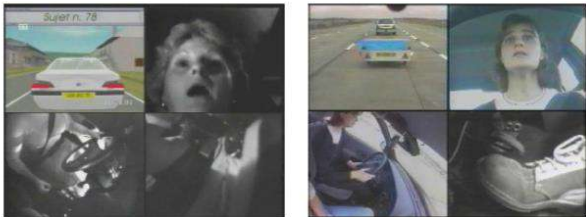
Figure I.2. Simulateur 3D pour analyser les réactions des conducteurs en situation d'urgence [16]
