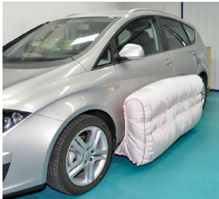
Figure II.15. Déploiement d'un airbag extérieur latéral [37].
