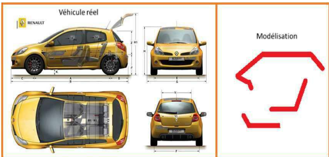
Figure V.5. Comparaison entre la géométrie du véhicule et de son modèle numérique 3D simplifié.
