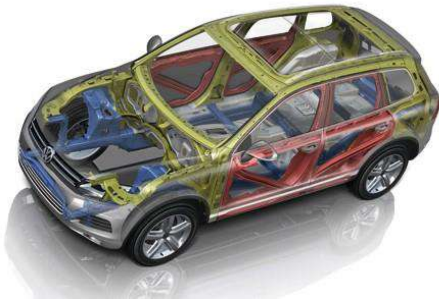
Figure I.5. Eléments de renfort mis dans la structure d'un véhicule pour l'aider à bien absorber de l'énergie lors d'une collision.
