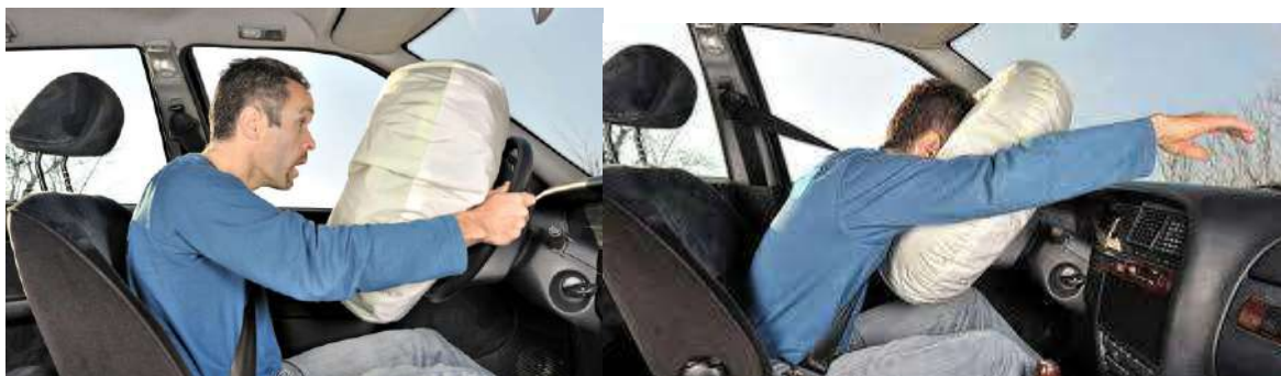
Figure II.9. Vulnérables des membres supérieurs d'un conducteur ceinturé en cas de crash [31].
