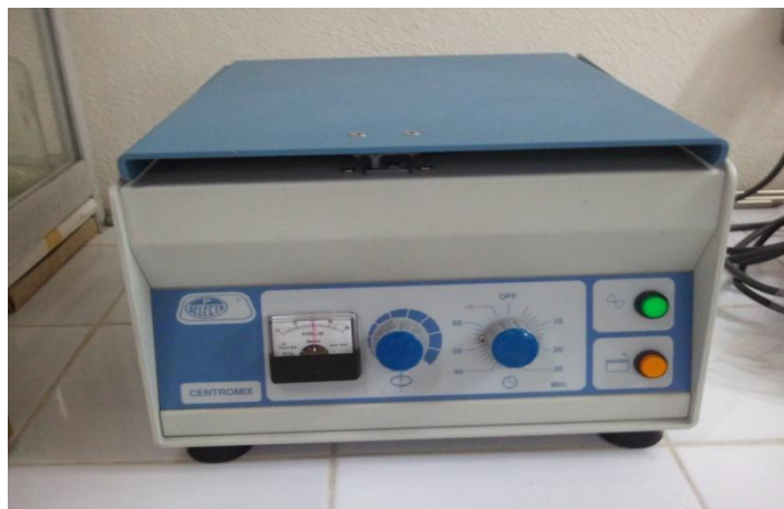
Figure 44 : Photo de la centrifugeuse utilisée. Centro mix selecta p.
