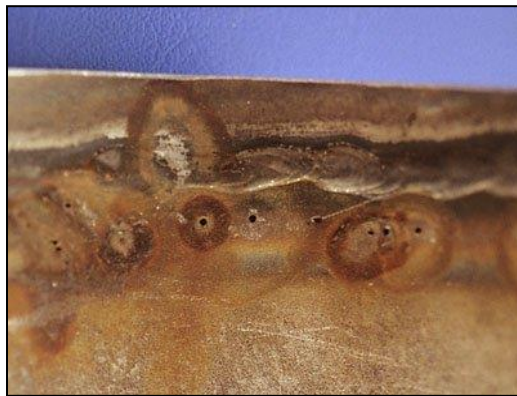
Figure II.2. Corrosion par piqûre.
