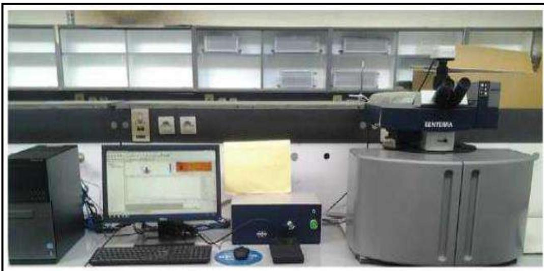
**Figure 1. 7 :** Spectrophotomètre Raman (Faculté des Sciences Exactes, Laboratoire de Cristallographie, Université Frères Mentouri Constantine 1).
