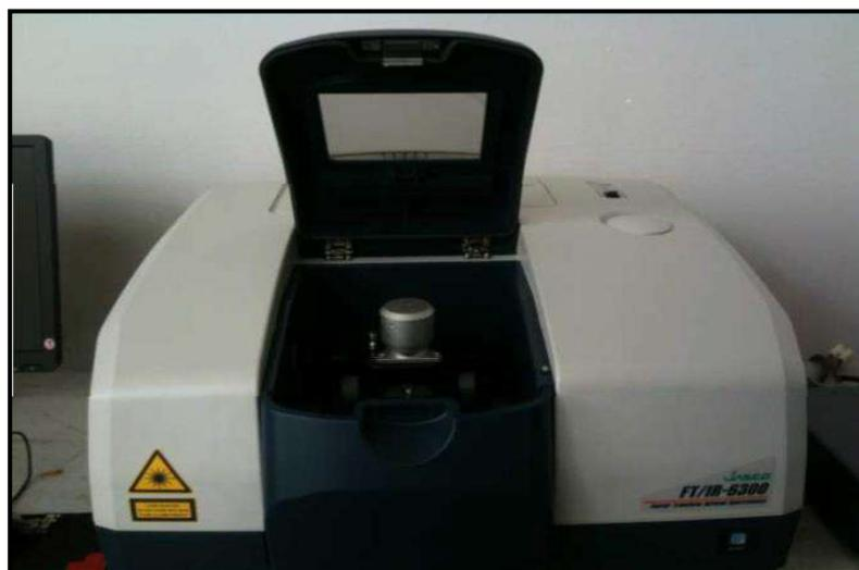
**Figure 1. 11 :** Spectrophotomètre Infrarouge (Faculté des sciences exactes, Laboratoire de Cristallographie Université Frères Mentouri Constantine 1.
