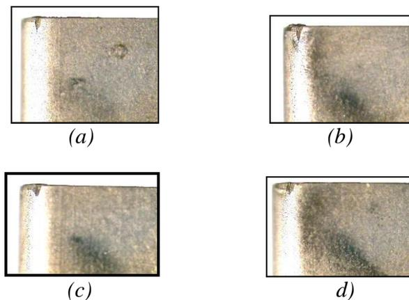
FIGURE 5. Aspect final de l'usure en dépouille principale VB de P35: a)  $V_c=120\text{m/mn}$ , b)  $V_c=150\text{m/mn}$ , c)  $V_c=180\text{m/mn}$ , d)  $V_c=250\text{m/mn}$ ,
