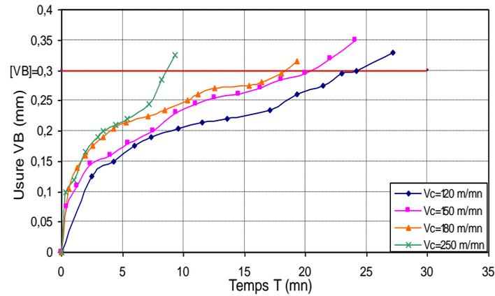
FIGURE 3. Evolution de l'usure en dépouille (VB) du P35 en fonction du temps pour différentes vitesses de coupe lors de l'usinage de l'acier C30.
