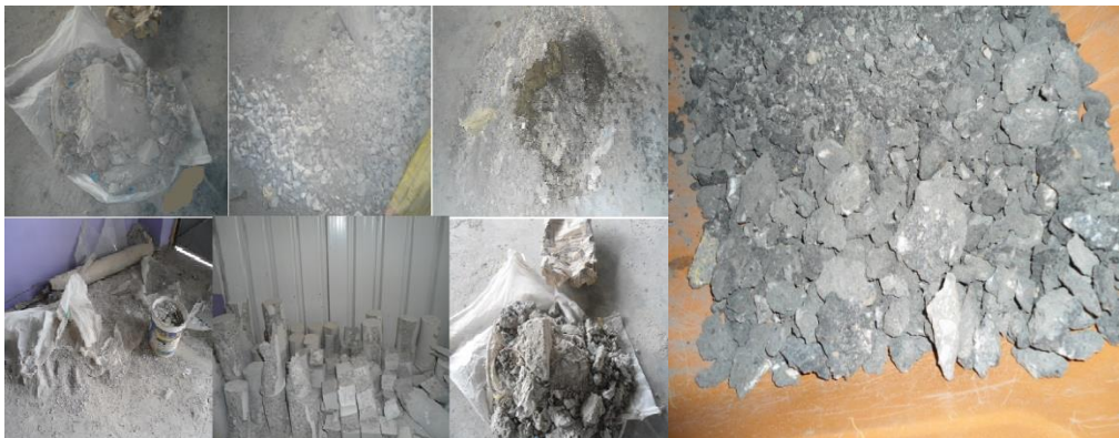
Figure 2 : Produit de démolition et fraisât de l'autoroute est-ouest
