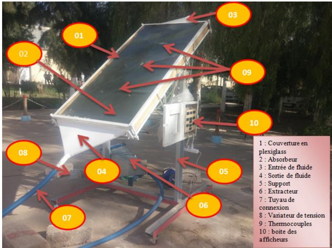
FIGURE 1. Différents constituants du panneau solaire plan à air [5]
