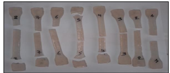
FIGURE 6. Eprouvettes normalisées en résine après l'essai de traction.
