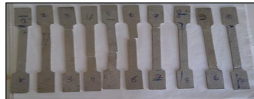
FIGURE 1. Eprouvettes selon la norme ISO3167. FIGURE 2. Les éprouvettes minces endommagées après l'essai de traction.
