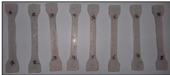
FIGURE 5. Eprouvettes normalisées en résine avant l'essai de traction.
