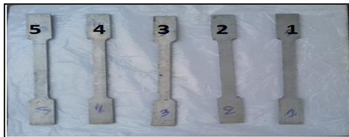
FIGURE 1. Eprouvettes selon la norme ISO3167. FIGURE 2. Les éprouvettes minces endommagées après l'essai de traction.
