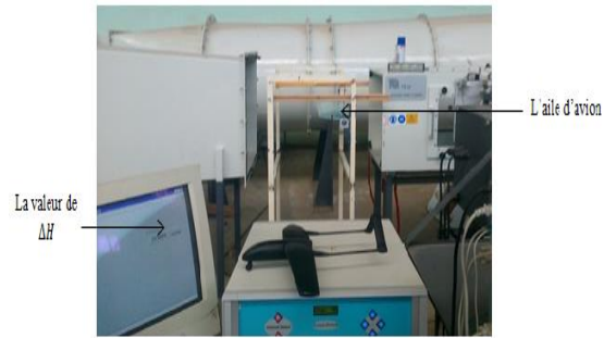
Figure 8. Le montage d'expérience dans la soufflerie
