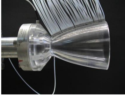
FIGURE 1. Image réelle de la tuyère DLR-TIC[7]
