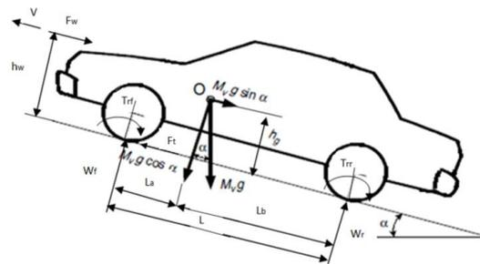
FIGURE 2. Les forces agissant sur un véhicule [11]
