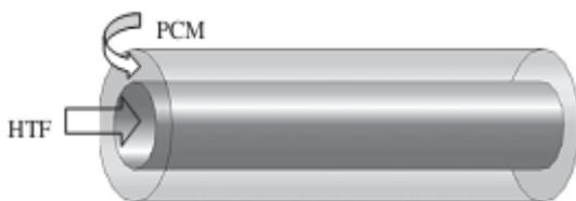
FIGURE 1.a. Schémas du système Shell-and-tube heat storage unit
