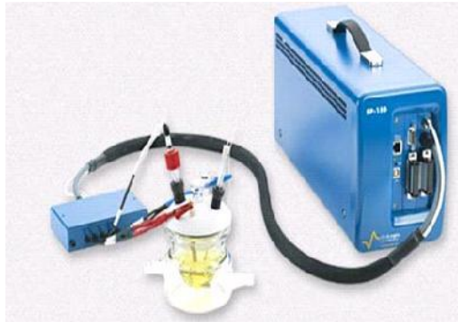
Figure 5 : Dispositif électrochimique utilisé a droite, courbe de polarisation de l'échantillon dépôt ZSM5 et substrat d'aluminium a gauche
