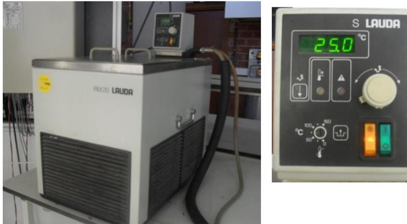
Figure 4: Photo du cryostat et son régulateur
