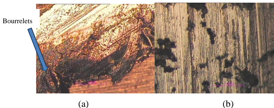
Figure 9 : Image obtenue par microscope optique de la surface usé du pion, (a) contact cuivre-graphite, (b) contact graphite-graphite pour P = 20N et V = 0,5m/s .
