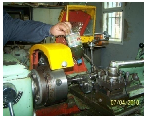
Figure 8 : engrènement avec lubrification
