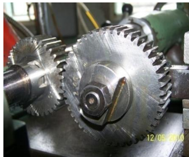
Figure 2 : Système d'engrenages roue-pignon
