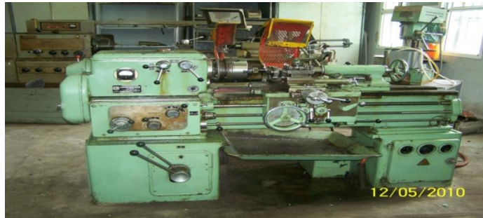
Figure 1 : Banc d'essai avec système d'engrenages entraîné par le mandrin d'un tour
