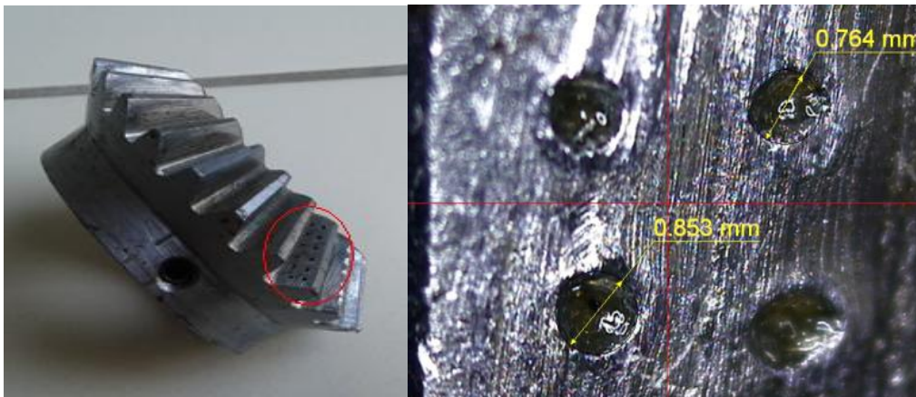
Figure. 5 : Pignon avec des piqures.
