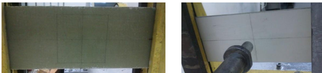
Figure 1 : Eprouvette d'essais de fatigue par choc (faces avant et arrière)
