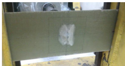
Rupture des fibres et délaminage sur la face arrière
