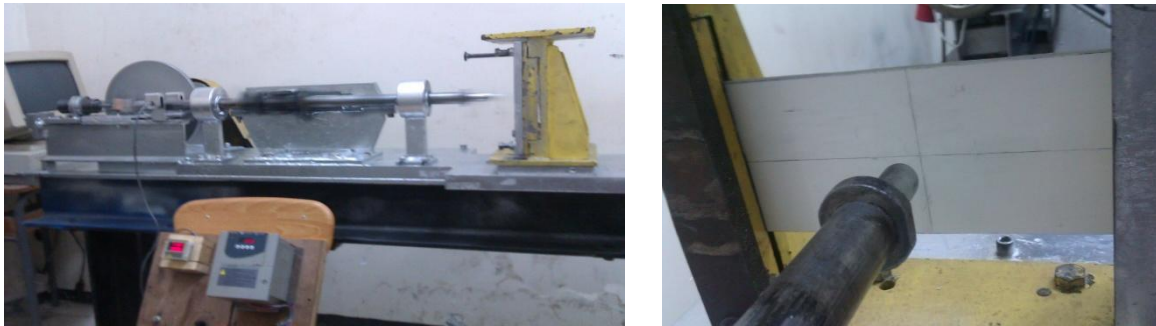
Figure 2: Machine de fatigue par chocs et Montage des éprouvettes
