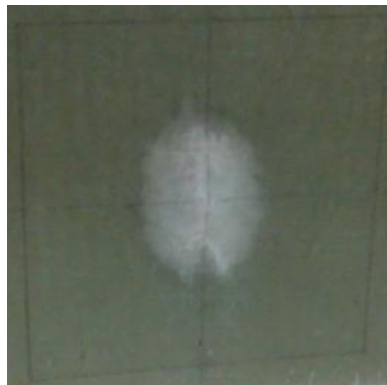
Figure 3: Endommagement par impacts sur un composite verre/polyester
