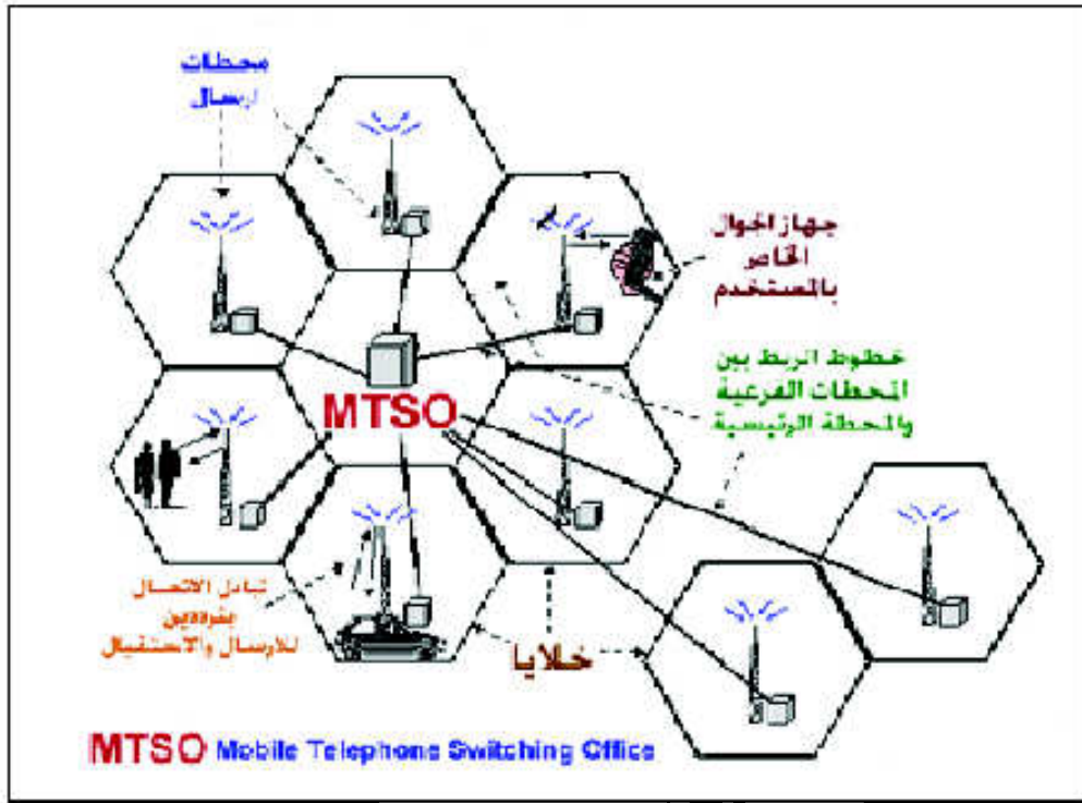
شكل رقم (29) طريقة عمل الشبكة الهاتفية
