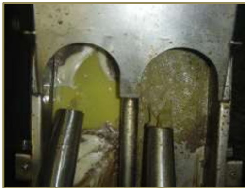
Figure 2 : Sortie d'une centrifugeuse 3-phases, à droite les grignons humides, à gauche l'émulsion huile/eau (Veillet, 2010)
