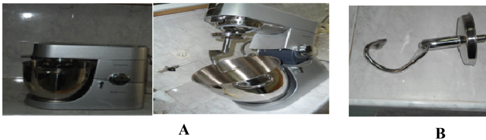
Figure 6. Photographie du pétrin Kenwood KM 02, A : pétrin, B : crochet à pâte.
