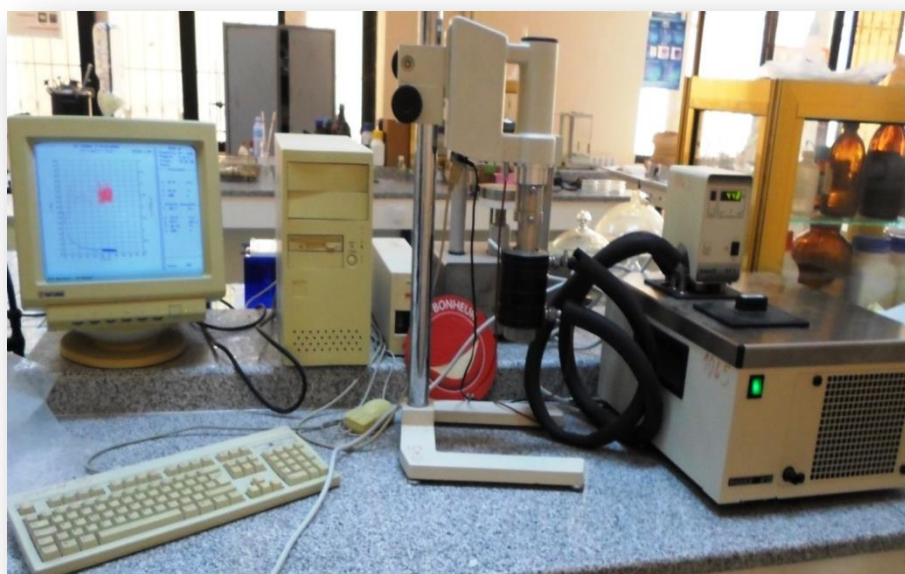
Axe "SV-DIN " pour la rhéologie des bouillies
