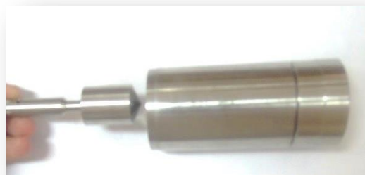
Axe "SV-DIN " pour la rhéologie des bouillies
