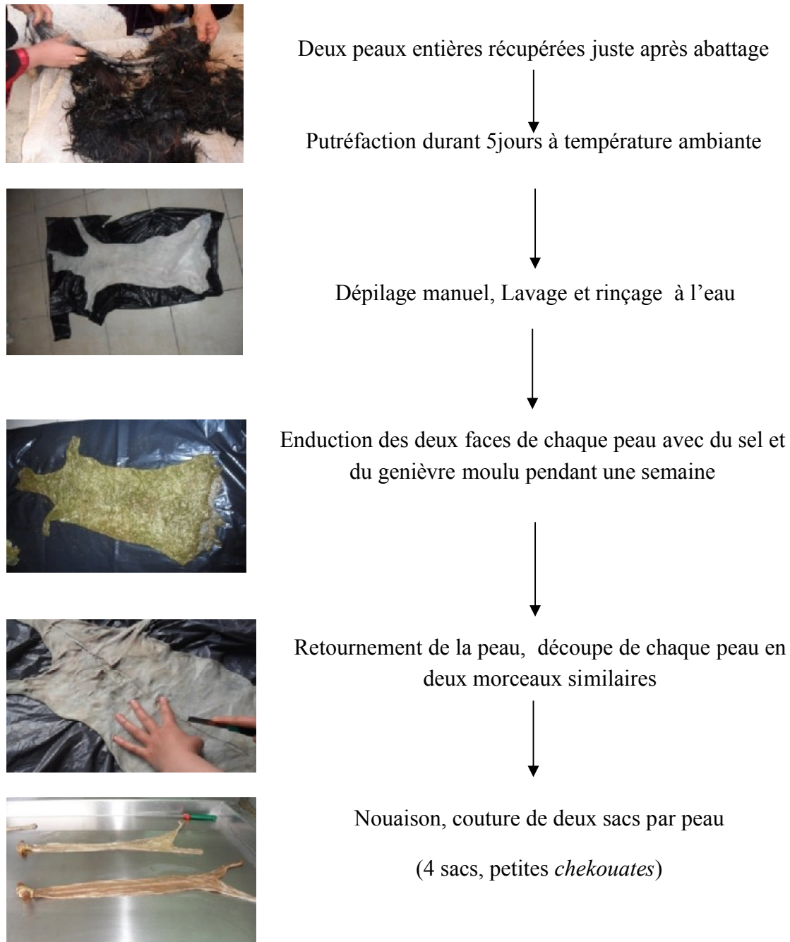
Figure 6. Schéma représentatif des différentes étapes de préparation de la peau de chèvre
