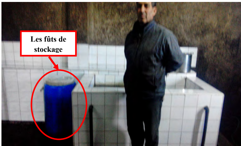
Photo III.12 : Nageoire de décantation et de séparation de l'huile (500-600 m 3 ) et fûts de stockage.
