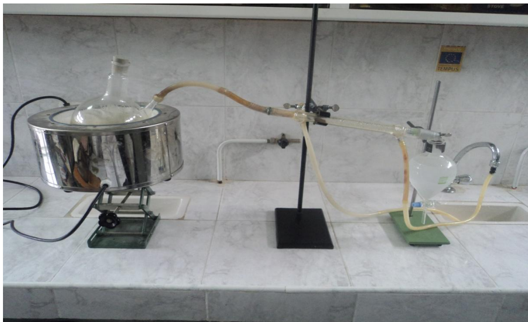
Annexe 1. Dispositif de l'hydrodistillation utilisé pour l'extraction de l'huile essentielle de P. chloranthus .
