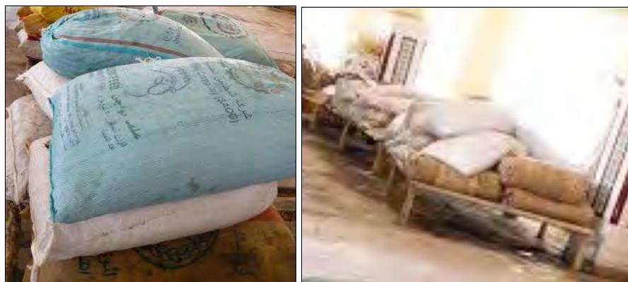
**Figures IV.33 et IV.34 : Entassement des sacs en plastiques perforées remplies des dattes sur des tables perforées**
