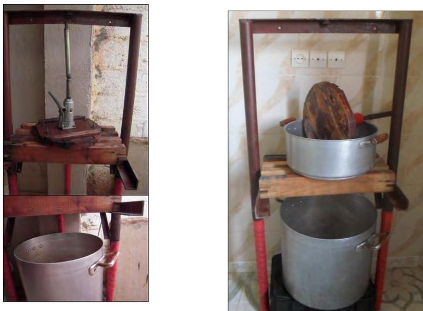
**Figure IV.14 et IV.15 : Opération de pressurage des résidus des dattes par torsion**
