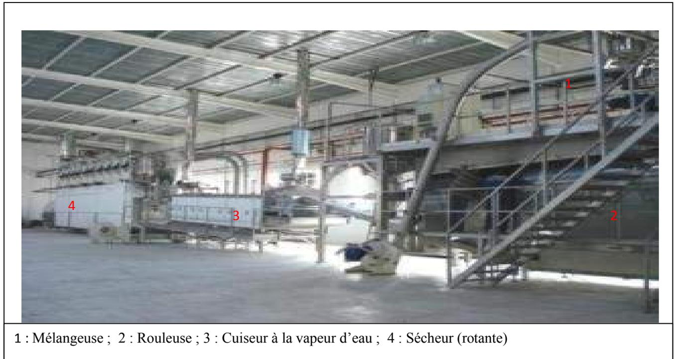
**Figure 1.** Chaîne AFREM pour la fabrication du couscous
