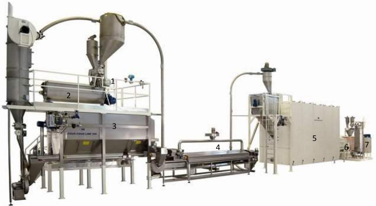
1 : Centrifugeuse pour hydratation homogène ; 2 : Mélangeuse ; 3 : Rouleuse ; 4 : Cuiseur à la vapeur d'eau ;
