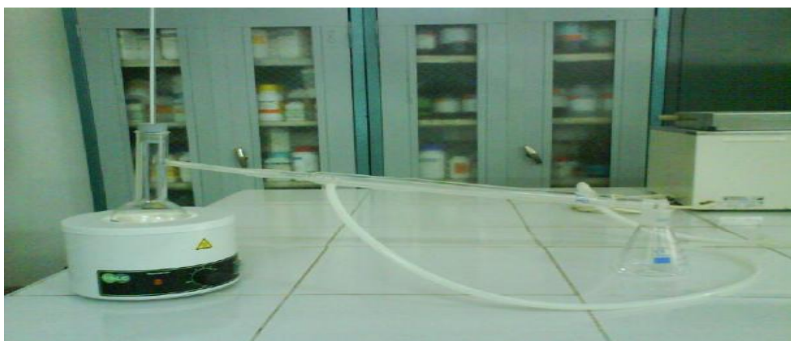
Figure 2 : dispositif de l'hydro distillation
