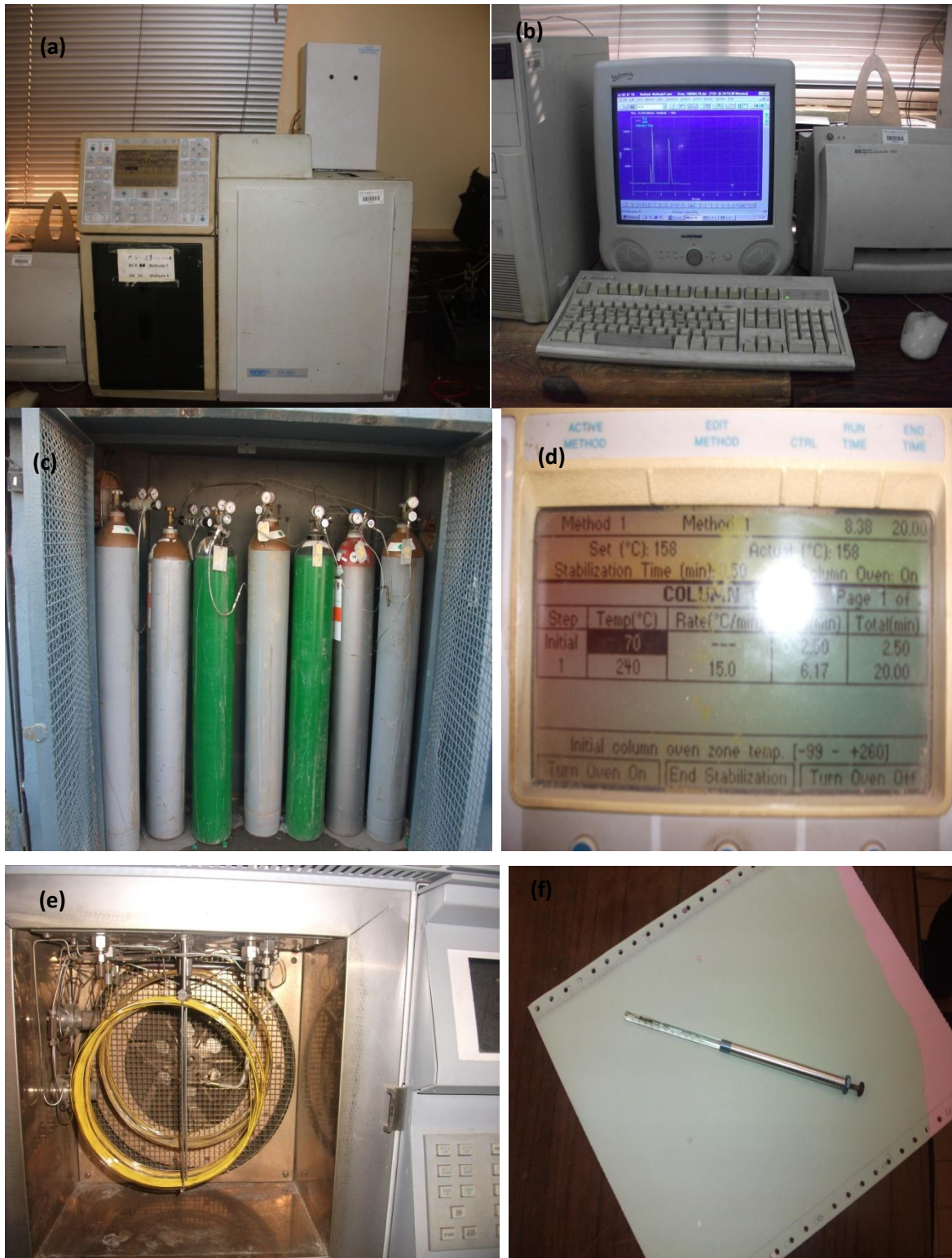
(a) :L'appareil utilisée pour la chromatographie type VARIAN CHROMPACK-CP 3800,(b) : un ordinateur menu d'un logiciel Nist,(c) :les bouteilles de gaz vecteurs utilisées pour la chromatographie en phase gazeuse,(d) tableau des paramètres de la colonne,(e) La colonne capillaire type CP-Chirasil-Dex CB fused silica WCOT,(f) micro-seringue d'injection.
