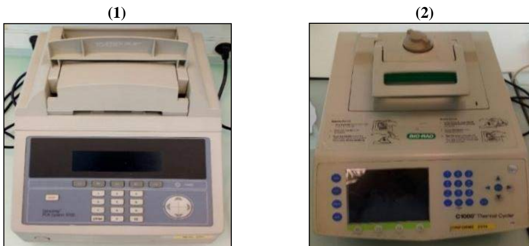
Figure 20. Thermocyclers utilisés pour les amplifications. : (1) Bio-Rad C1000 gradient ; (2) GenAmp PCR system 9700 PE (Perkin-Elmer, Courtaboeuf, France)
